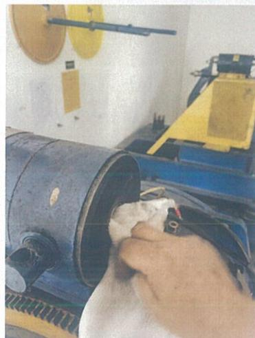
4.8 把碟簧放入电磁芯凹孔、吸板导杆插入电磁铁芯孔，将高温导线穿过吸板的引线孔。
