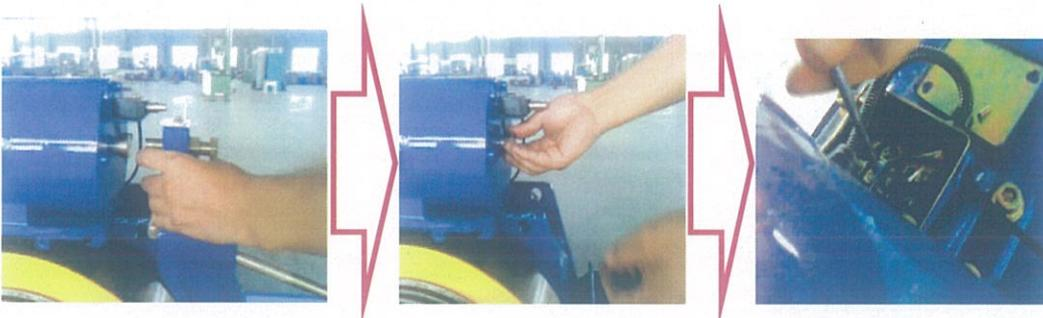
4.3 剪掉引出线接线鼻子，松开制动器引出线处螺母取下原有套管。
