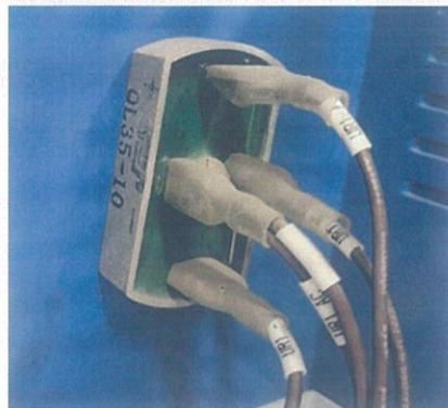
2、将桥整流桥负极接线取下；
