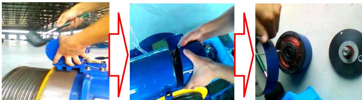
4.7 把碟簧放入电磁芯凹孔、吸板导杆插入电磁铁芯孔，高温导线穿过吸板的引线孔。
