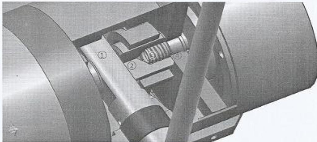
当手动松闸时，搬动松闸手柄，1号件转动顶出2号件，2号件在固定的限位圈中，只能横向移动推动4号件（活动铁）向外克服制动弹簧压力，从而达到松闸的效果。
